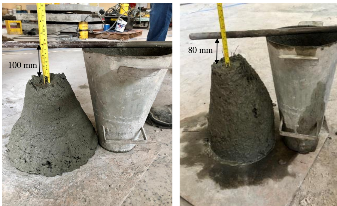
Figura 43 - Abatimento de tronco de cone em concreto das lajes SC.e SCF, respectivamente.
