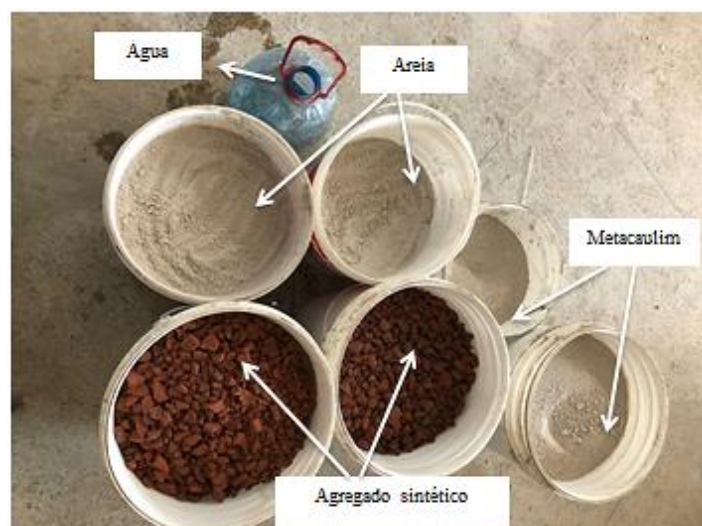
Figura 45 - Água, metacaulim, agregado sintético e areia.
