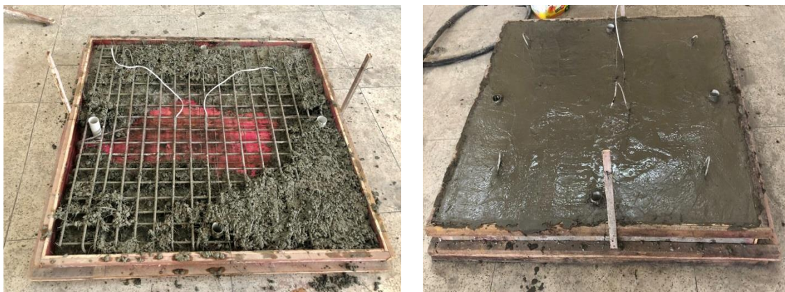
Figura 57 - Concreto da laje SCRMF em estado fresco.
