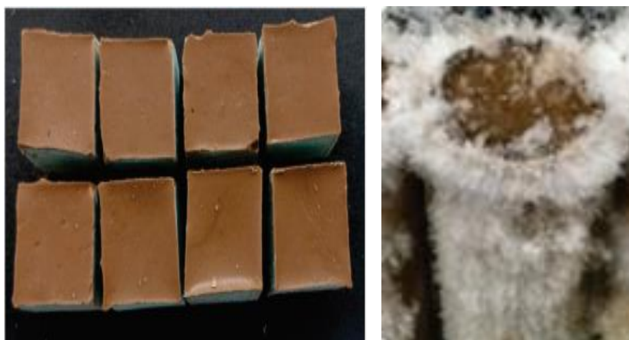
Figura 13 - CPs retirado das formas após endurecimento; CP com eflorescência, LERMEN et al. (2022).
