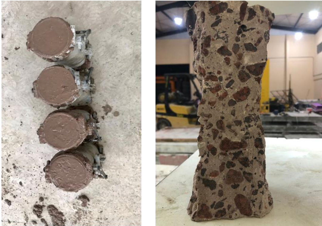
Figura 53 - Corpos de prova em estado fresco e rompido após 45 dias.
