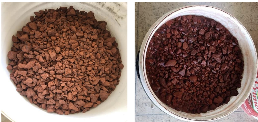
Figura 52 - Agregado graúdo sintético de resíduo de bauxita seco e em saturação.
