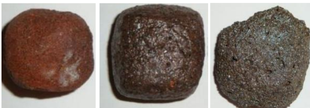
Figura 7 - Efeito da temperatura na expansão do agregado sinterizado, respectivamente, a 1200°C, a 1250°C e a 1300°C, por SOUZA; RACANELLI & QUARESMA (2021).
