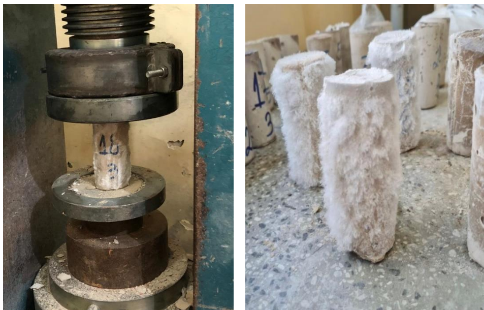
Figura 46 - Corpos de prova de (50 x 100) mm de argamassas geopoliméricas em ensaio de compressão axial e, ao lado, CP's com eflorescência.
