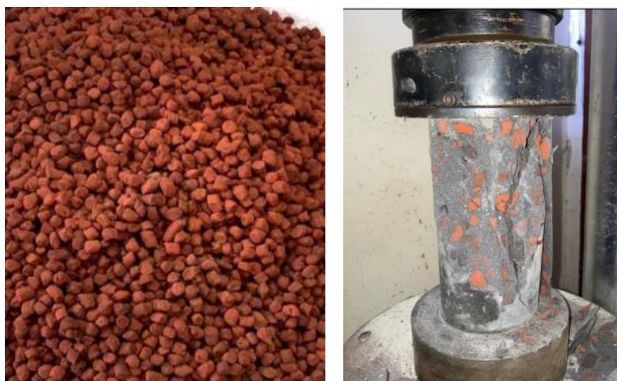
Figura 8 - Agregado utilizado e corpo de prova em ensaio de compressão axial, por RIBEIRO (2022).
