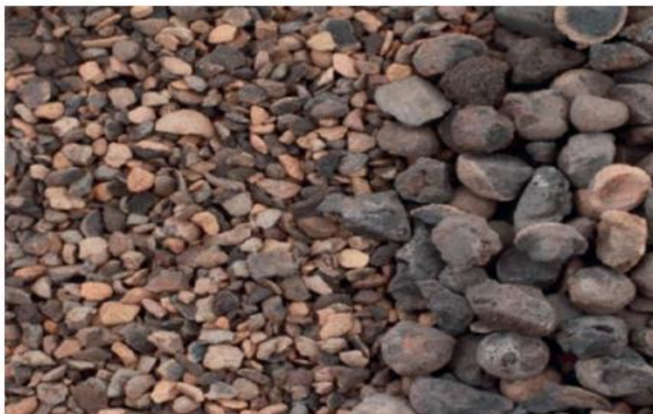
Figura 19 - Agregado sintético de cinza volante de GOLDYN & URBAN (2022).
