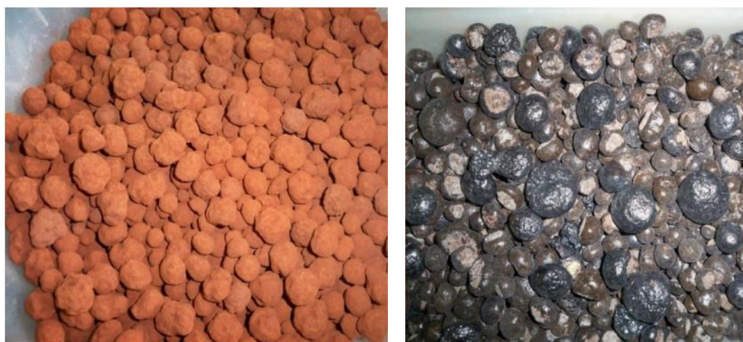
Figura 6 - Agregado sintético produzido por ROSÁRIO (2013).
