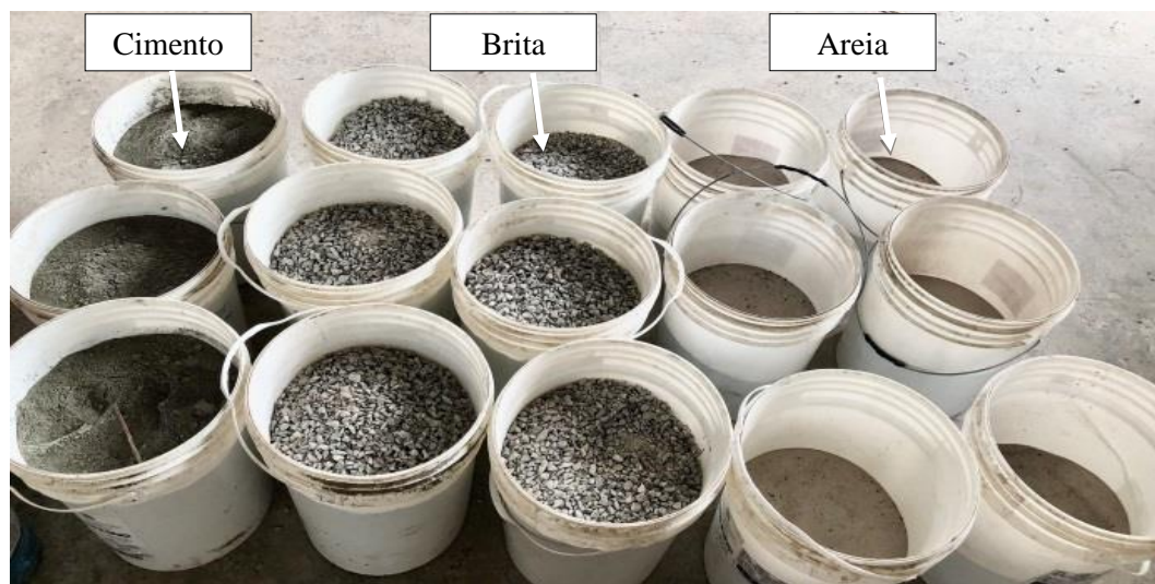
Figura 42- Materiais das lajes de concreto convencional, cimento, brita 0 e areia.
