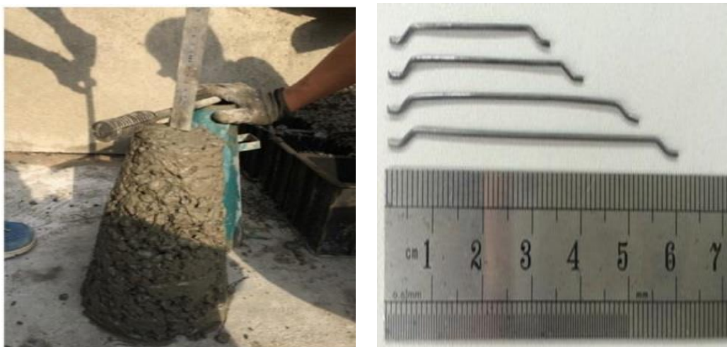
Figura 11 - Ensaio de abatimento de tronco de cone e fibras utilizadas por HAN et al. (2019).
