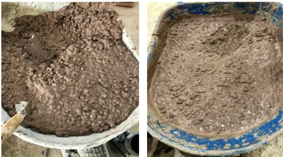
Figura 51 - Geopolímero com agregado graúdo sintético de resíduo de bauxita.
