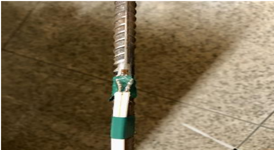
Figura 35 - Extensômetria na barra da armadura de flexão.
