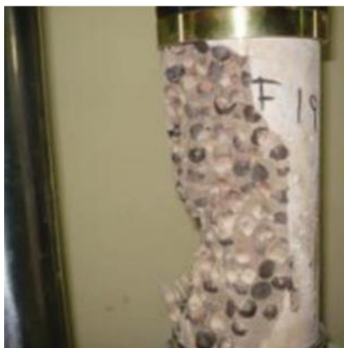
Figura 5 - Agregado sintético produzido por ROSSI (2009).
