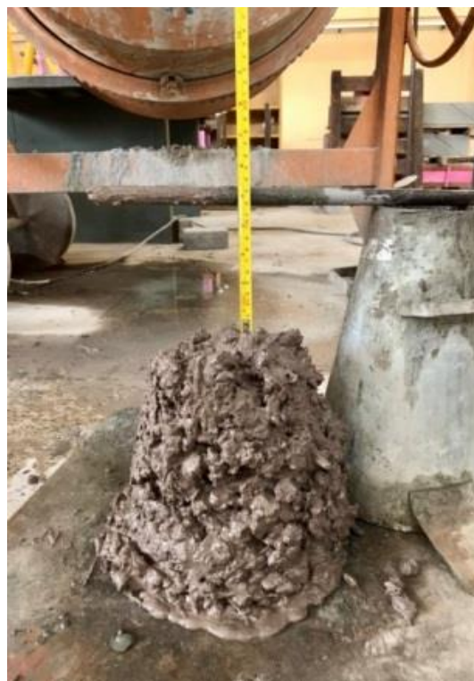
Figura 55 - Concreto geopolimérico com AGS-80 e fibras de aço.
