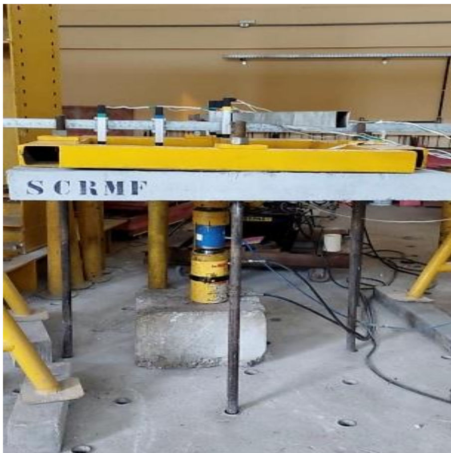
Figura 41 - Sistema de ensaio com a laje.
