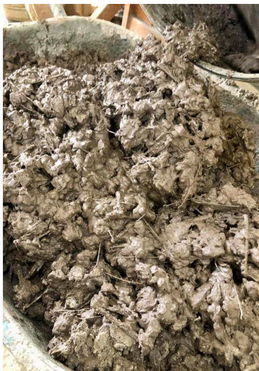
Figura 55 - Concreto geopolimérico com AGS-80 e fibras de aço.
