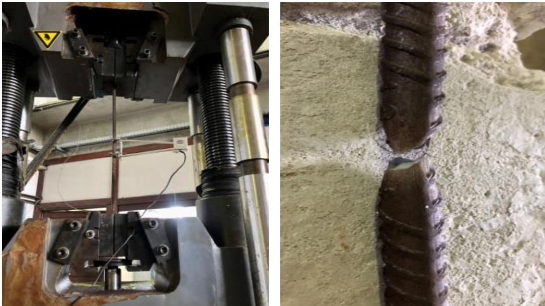
Figura 56- Ensaio de tração em barra de 10,0 mm.
